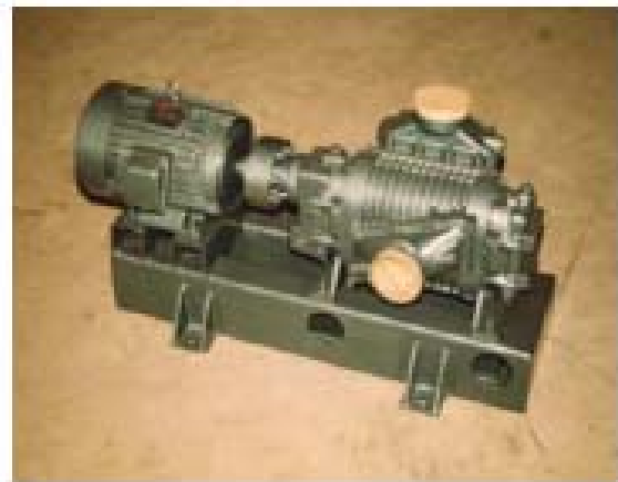
Blower: 'Roots' type untuk peniupan udara membuat es jernih
