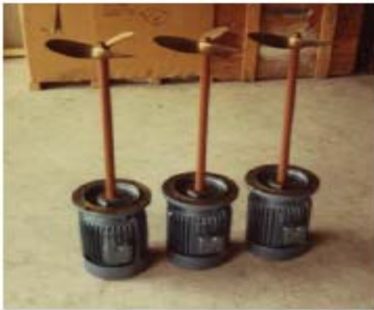
Agitator: dengan propeller, tangkai dan flange motor
